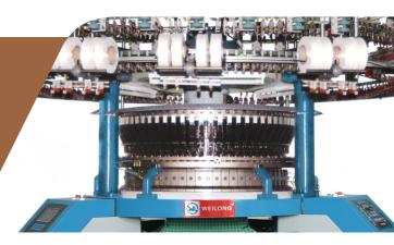
编织优势 KNITTING ADVANTAGE 采用纬龙立式变色头:操作方便、不积尘、无纱尾、少飞毛。对于不同成分、 粗细的编织原料,都能切割自如,夹线牢固。采用高速二功位(成圈、集圈、 浮线)电脑选针技术,可达到高速稳定的优越编织效果。
