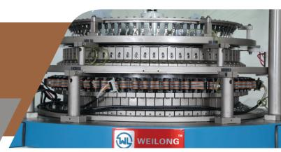
编织优势 KNITTING ADVANTAGE 此机是本公司最新研发并申请了多项专利的权威机型,是世界上首台功能最齐全、工艺最完整的四线卫衣电脑提花机。此机克服了传统三线卫衣提花机在编织时出现毛圈漏底,正面花型图案的背面无毛圈,无法实现双色毛圈提花以及布面颜色少等缺陷。
