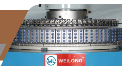
编织优势 KNITTING ADVANTAGE 织棉毛布时布面平整、条杆清晰,无横条、暗影。此外还可织格子布、提花布、直条布以及高品质、高要求的强捻、假捻罗马布。尤其是两面棉加氨纶中间单丝的空气层布优势特别显著。(山角系统上二下四,可定制上四下六)。
